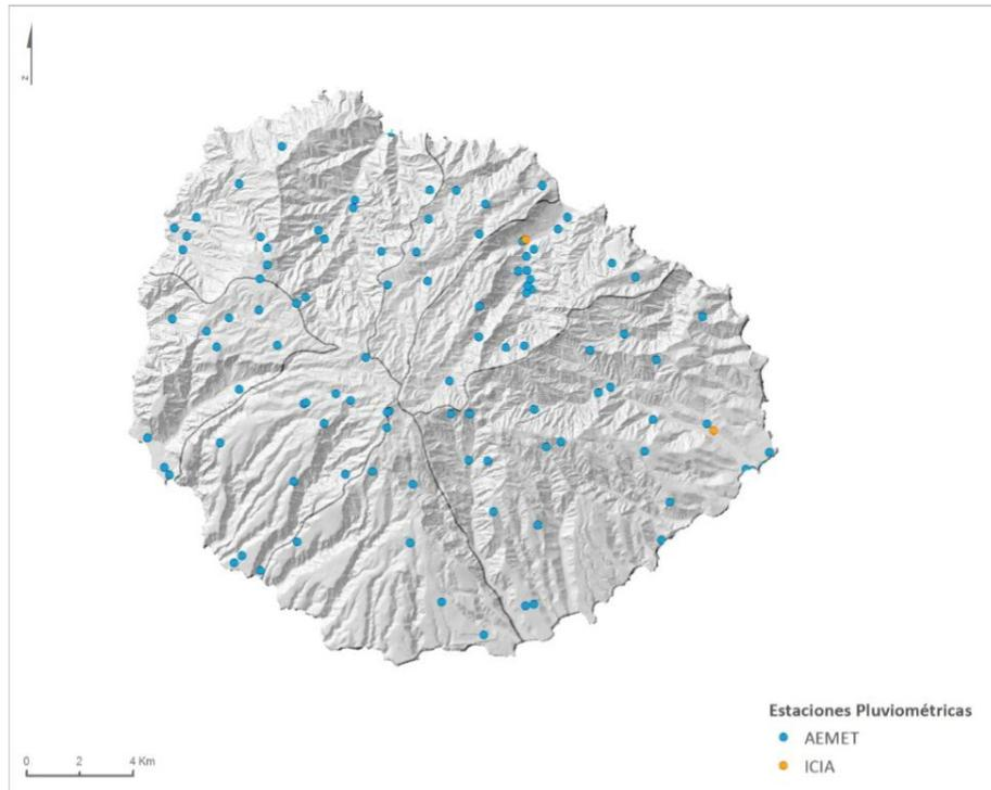
Figura 19. Red de pluviómetros
